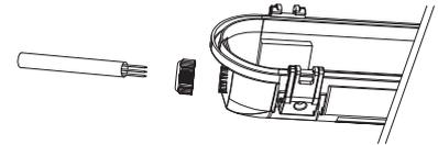
② Verbinden Sie das Anschlusskabel wie in der unteren Abbildung dargestellt.
