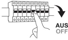
**A** Schalten Sie spannungsfrei.
