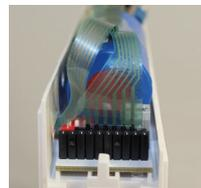
**Achtung! Bei Anschluss des Prüftasters ist darauf zu achten, dass die Kontaktseite des Kabels zur Platinenrichtung zeigt, sonst keine Funktion!**
