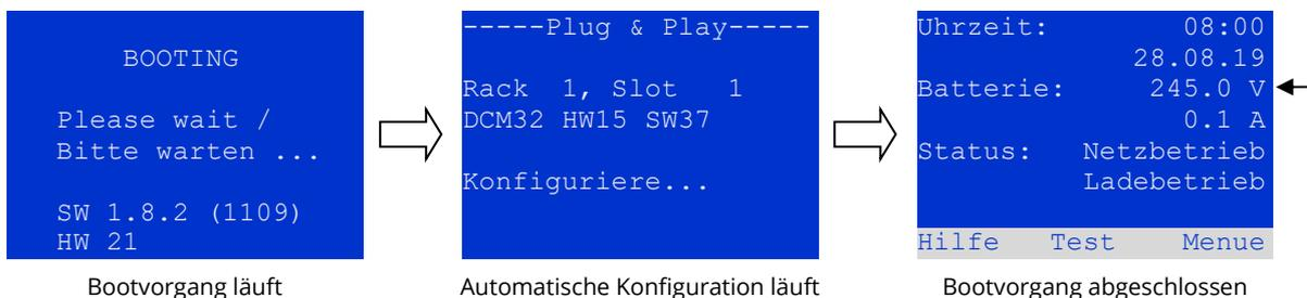
Abbildung 13: Bootvorgang (links, Mitte) und Statusanzeige (rechts).
