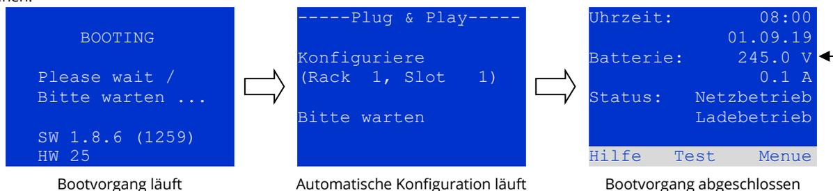
Abbildung 3: Bootvorgang (links, Mitte) und Statusanzeige (rechts).
