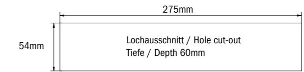
Lochausschnitt / Hole cut-out Tiefe / Depth 60mm
