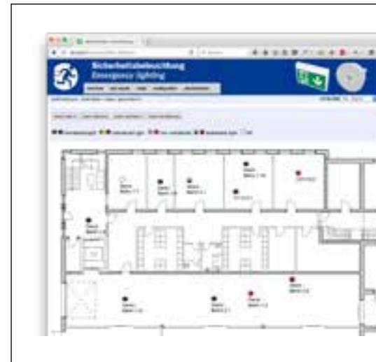
Les plans du bâtiment enregistrés individuellement permettent de trouver facilement les luminaires défectueux.
