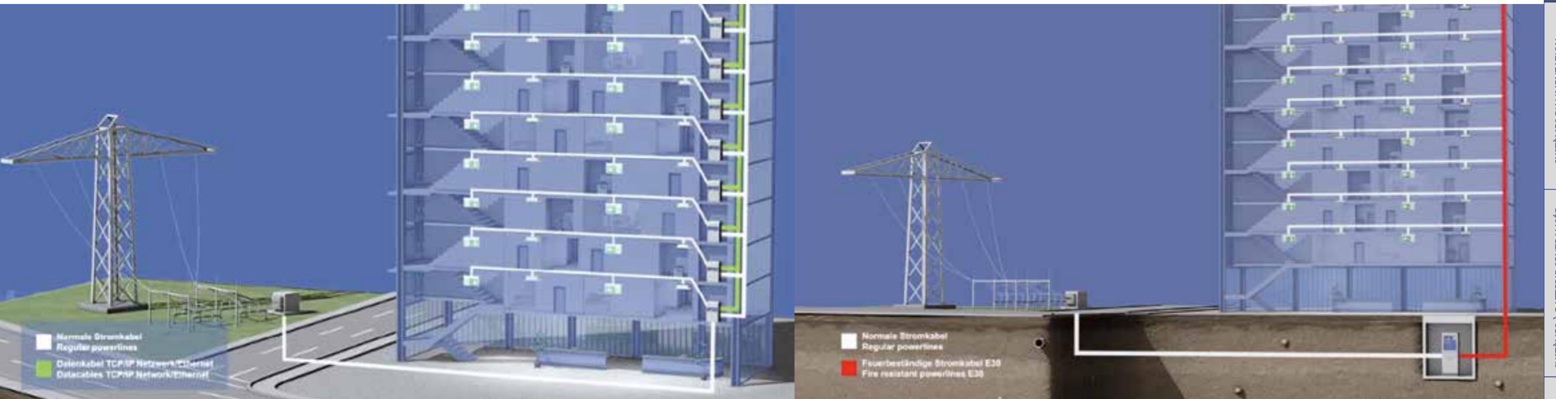
Les systèmes d'alimentation électrique à puissance limitée (Low Power System) constituent le concept de la décentralisation du système d'éclairage de sécurité dans les compartiments coupe-feu, pour l'alimentation de luminaires de secours et de sécurité dans le compartiment coupe-feu. Grâce à ce concept décentralisé, l'utilisation de câbles électriques en maintien de fonction pour alimenter des luminaires conformément à la norme MLAR 2005 devient superflue.
