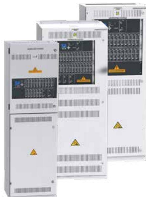
Les systèmes à batterie centralisée sans limitation de puissance constituent le concept de systèmes d'éclairage de sécurité dans les compartiments coupe-feu, pour l'alimentation de luminaires de secours et de sécurité à partir d'un point central. L'alimentation des différents compartiments coupe-feu s'effectue à l'aide de câbles en maintien de fonction.
