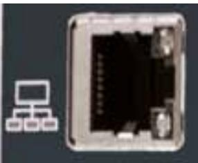
L'interface Ethernet intégrée dans l'unité de commande permet de programmer complètement le système par interface web et de le surveiller.
