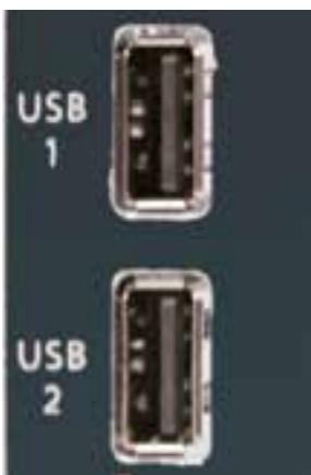
Les ports USB intégrés offrent la possibilité d'un clavier USB standard, pour configurer le système sur le LCD, raccorder une imprimante externe (PCL6) et effectuer des mises à jour du firmware avec une clé USB.
