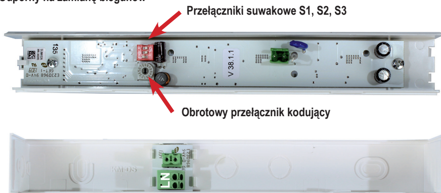
Górna część z zaciskami pod okablowanie przejściowe (maks. 2,5 mm 2 )
