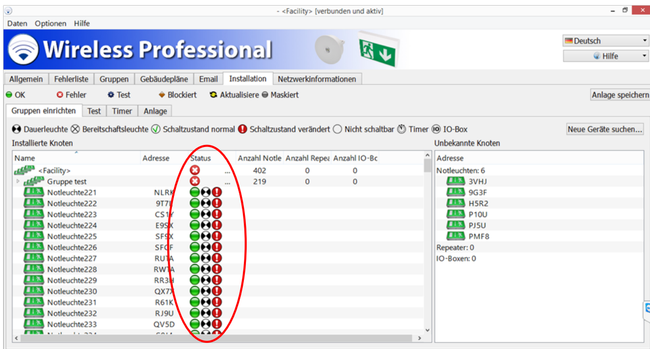
Abbildung 6: Installation, Gruppe einrichten mit zugewiesenen Leuchten
