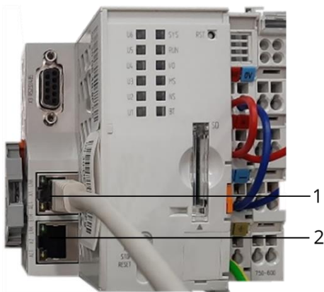
Abbildung 4: Anschluss Netzwerk MC BMS-EXT 7508212/00-100
