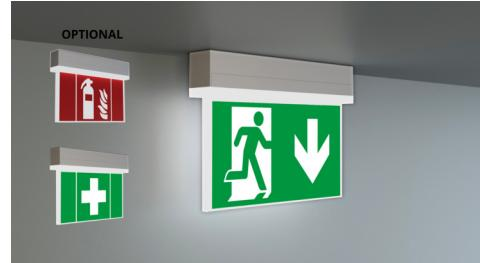
Durch den Verrastmechanismus zwischen Ober- und Unterteil wirkt die Leuchte harmonisch und rundum geschlossen. Der Netzanschluß erfolgt im Deckenabaukörper, beim Schließen der Leuchte erfolgt die Versorgung der Leuchte über Steckkontakte. Dies erleichtert ungemein die Montage und ermöglicht trotz der geringen Größe der Leuchte einen bequemen Anschluß.
