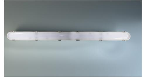
LED-Wannenleuchte, Serie VASCA. Gehäuse aus Polycarbonat. Prismatischer Diffusor aus UV-resistentem PC. Die Befestigung des Diffusors erfolgt mit Edelstahlclipsen. Die LED Platine ist einzeln austauschbar. Zudem verfügt die Leuchte über eine Durchgangsverdrahtung.
