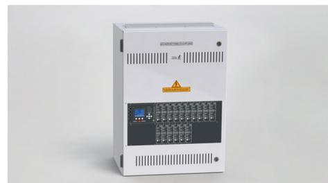
Das System midiControl plus Unterstation MDUS ist ein vielseitig einsetzbares Stromversorgungssystem gemäß DIN EN 50171 zur Versorgung von Sicherheits- und Rettungszeichenleuchten mit 230 V / 216 V AC/DC. Es eignet sich für Sicherheitsbeleuchtungsanlagen nach DIN VDE 0100-560, DIN EN 50172 sowie DIN VDE V 0108-100 und kann mit bis zu 32 frei programmierbaren Stromkreisen im wartungsfreundlichen 19"-Baugruppensystem ausgestattet werden.
