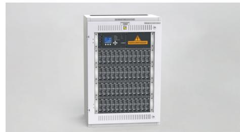
Das System multiControl plus Unterstation UCW (Wandgehäuse) ist ein universell einsetzbares, zentrales Stromversorgungssystem nach DIN EN 50171 zur Versorgung von Sicherheits- und Rettungszeichenleuchten 230V / 216V AC/DC. Geeignet für Sicherheitsbeleuchtungsanlagen gem. DIN VDE 0100-560, DIN EN 50172 und DIN VDE V 0108-100, welches mit bis zu max. 84 frei programmierbaren Stromkreisen mit unterschiedlichen Leistungsbereichen im servicefreundlichen 19"-Baugruppensystem ausgestattet sein kann.
