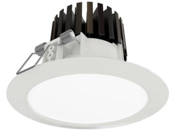
Downlight LED à encastrer ou en saillie, série RAVIO. IP20 (pour la version montée en saillie). Boîtier en plastique (PC) et radiateur passif en aluminium. Diffuseur en plastique, opale. Module de commande commutable ou intensité variable DALI, externe (intégré sur la version montée en saillie). Modèle disponible avec commande Bluetooth Casambi. Compatibilité DC sur demande.
