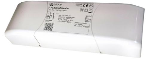
Das CASA DALI Master Modul bietet die kabellose Steuerung von DALI Leuchten/ Netzteilen. Dabei ermöglicht die großzügig ausgelegte DALI-Busstromversorgung von max. 100mA die Anbindung mehrerer DALI Leuchten/Netzteile an ein Modul. Daraus ergibt sich für den Anwender ein entscheidender Kostenvorteil. Zugentlastung und Klemmenabdeckung sind integriert.
