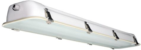
LED-Feuchtraumleuchte, Serie LUKA, IP66. Ammoniak und Öl beständig. Gehäuse aus Stahlblech. Diffusor aus Sicherheitsglas. Durchgangsverdrahtung vorhanden. Netzteil, schaltbar oder DALI dimmbar, integriert. DC Tauglichkeit und NANO Schutz auf Anfrage. Geeignet für Einsatz in der Lebensmittelindustrie. Anwendungsbereich: Autowaschen, Chemische Industrie, Küchen etc.
