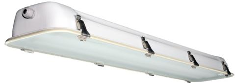
LED-Feuchtraumleuchte, Serie LUKA, IP66. Ammoniak und Öl beständig. Gehäuse aus Stahlblech. Diffusor aus Sicherheitsglas. Durchgangsverdrahtung vorhanden. Netzteil, schaltbar oder DALI dimmbar, integriert. DC Tauglichkeit und NANO Schutz auf Anfrage. Geeignet für Einsatz in der Lebensmittelindustrie. Anwendungsbereich: Autowaschen, Chemische Industrie, Küchen etc.
