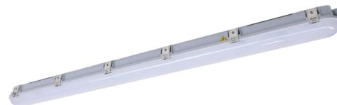
LED-Wannenleuchte, Serie VASCA, IP65, IK08. Gehäuse aus Polycarbonat. Prismatischer Diffusor aus PC, UV-resistent. Befestigung des Diffusors mit Edelstahlclipsen. LED Platine einzeln austauschbar. Betriebsgerät, schaltbar oder DALI dimmbar eingebaut. Durchgangsverdrahtung vorhanden. Ausführung mit Casambi Bluetooth Steuerung verfügbar. DC tauglich.
