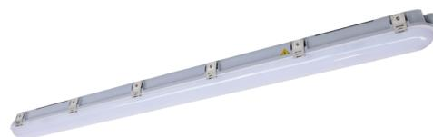
Diffuseur LED, série VASCA, IP65, IK08. Boîtier en polycarbonate. Diffuseur prismatique en PC, résistant aux UV. Fixation du diffuseur avec clips en acier inoxydable. La carte LED peut être remplacée individuellement. Appareil de commande, commutable. Câblage traversant disponible. Version avec contrôle Bluetooth Casambi disponible. Compatible CC.
