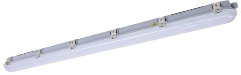
Luminaire vasque LED, série VASCA, IP65, IK08. Boîtier en polycarbonate. Diffuseur prismatique en PC, résistant aux UV. Fixation du diffuseur par pinces en inox. Platine LED individuelle remplaçable. Module de commande commutable ou intensité variable DALI intégré. Câblage direct existant. Modèle disponible avec commande Bluetooth Casambi. Compatible DC.
