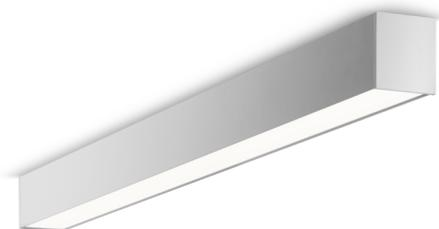
LED-Decken- und Wandleuchte, Serie LARO, direkt und direkt/indirekt strahlend. Gehäuse aus Aluminium, weiß, pulverbeschichtet. Diffusor Kunststoff (PMMA) mikroprismatisch, UV-stabilisiert. Betriebsgerät schaltbar oder DALI dimmbar, integriert. UGR < 19 und Bildschirmgerecht gemäß EN 12464-1. Ausführung mit Casambi Bluetooth Steuerung verfügbar.
