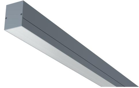
Luminaire LED mural et plafonnier, série MAVS. Boîtier en aluminium, blanc, avec revêtement par poudre. Diffuseur en plastique (PMMA), opale, résistant aux UV. Module de commande commutable ou intensité variable DALI, intégré. Modèle disponible avec commande Bluetooth CASAMBI®. Compatible DC.
