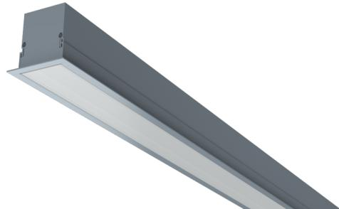
Luminaire LED mural et plafonnier, série MAVS. Boîtier en aluminium, blanc, avec revêtement par poudre. Diffuseur en plastique (PMMA), opale, résistant aux UV. Module de commande commutable ou intensité variable DALI, intégré. Modèle disponible avec commande Bluetooth CASAMBI®. Compatible DC.
