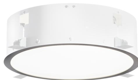
LED-Decken- und Wandleuchte, Serie PORIO, Einbau, als grundlegende Lichtausstattung für Geschäfts- und Wohnräume. Gehäuse aus Stahlblech, weiß, pulverbeschichtet. Diffusor Kunststoff (PMMA) opal, UV-stabilisiert. Betriebsgerät schaltbar oder DALI dimmbar, integriert. Ausführung mit Casambi Bluetooth Steuerung verfügbar. DC tauglich.
