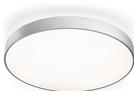
LED-Decken- und Wandleuchte, Serie RONDO, direkt/indirekt strahlend, als grundlegende Lichtausstattung für Geschäfts- und Wohnräume. Gehäuse aus Aluminium, weiß, pulverbeschichtet. Diffusor Kunststoff (PMMA) opal, UV-stabilisiert. Betriebsgerät schaltbar oder DALI dimmbar, integriert. Ausführung mit Casambi Bluetooth Steuerung verfügbar. DC tauglich.
